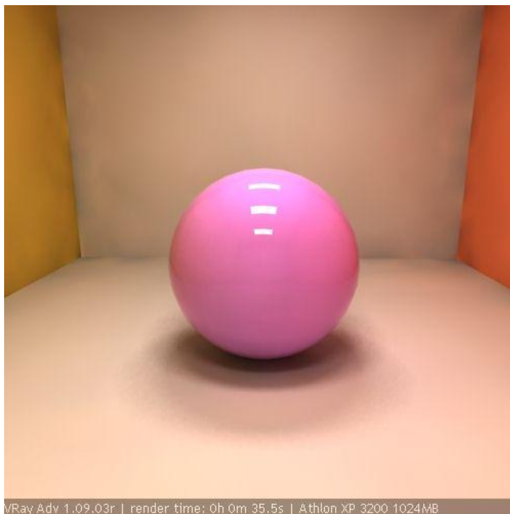
Рис.02-10. Время расчета для обоих значений Amount = 1, Noise threshold=0.1. Уменьшение Noise threshold еще больше ускорило расчет, но совершенно погубило качество изображения (шум в углах и на стыках стен и пола, "зернистость" тени).
